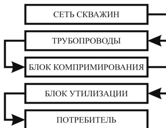
Рисунок 4 – Блок схема установки для добычи и утилизации биогаза
